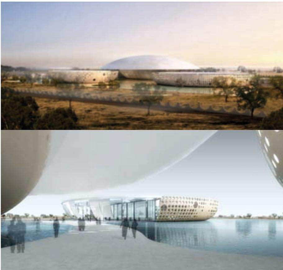
Inspirés par laalebasse, les volumes sont constitués de béton architectural préfabriqué, perforé ou imprimé sur ses parois par de multiples cercles à la double fonction de motif décoratif, inspiré de la «alebasse » traditionnelle, et de filtre solaire sur la deuxième paroi. Un grand dôme en membrane textile crée un tampon de température sur l'espace inférieur et définit une canopée à la promenade extérieure, circuit de prestige menant les chefs d'états et de gouvernement vers le complexe.
